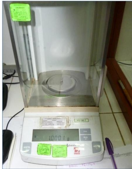
*Figura 7.* Verificación de la balanza analítica antes de los pesos de muestras. se realiza la verificación de la balanza con una pesa patrón de 1.0001 g, para resultados más precisos los equipos como la balanza y la pesa han sido calibrados previamente.
