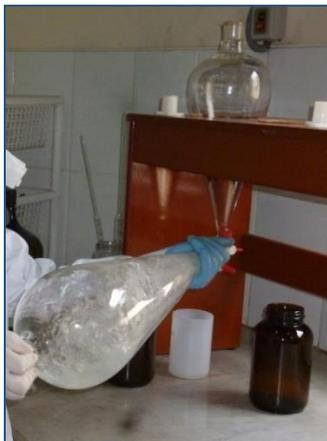
*Figura 9.* Agitación de muestra con Cloruro de Metileno. Se observa la agitación vigorosa de la muestra, se realiza la liberación de aire, para evitar que la presión que aumenta se libere de forma no controlada. El uso de Equipo de Protección Personal tales como mascarilla, guantes, mandil son importante antes de trabajar con muestras y reactivos químicos.
