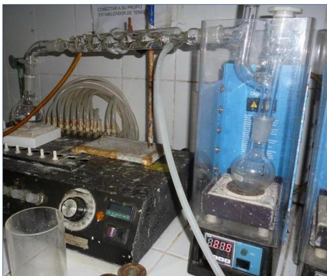
*Figura 12.* Destilación de la fracción > C<sub>10</sub>. se aprecia el Balón N° 1 (derecha) en una manta de calentamiento de hasta 170°C, al lado izquierdo se observa al Balón N° 2, con la función de recibir los gases transportados. Se observa un destilador de vidrio para mejorar el desempeño de transporte.
