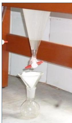
*Figura 10:* Proceso de separación de fases. Se observa que la fase orgánica es recibida en el balón de destilación, es necesario el Sulfato de Sodio Anhidro para eliminar las trazas de agua en la fase acuosa. Las muestras son filtradas durante 10 minutos.
