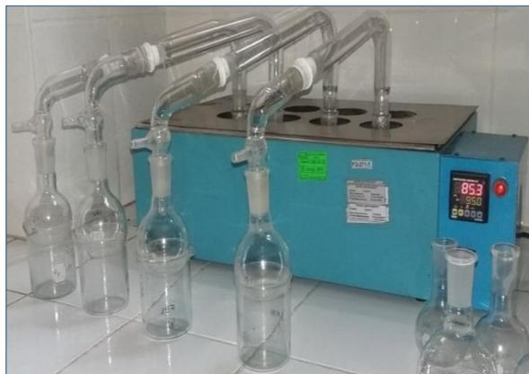
*Figura 11.* Destilación de la fracción C<sub>5</sub> – C<sub>10</sub>. se realiza el calentamiento del Balón de destilación N°1 en un equipo Baño de agua, los gases de dicho recipiente son transportados al Balón de destilación N° 2, el cual presenta una temperatura baja, para que los gases descendan.
