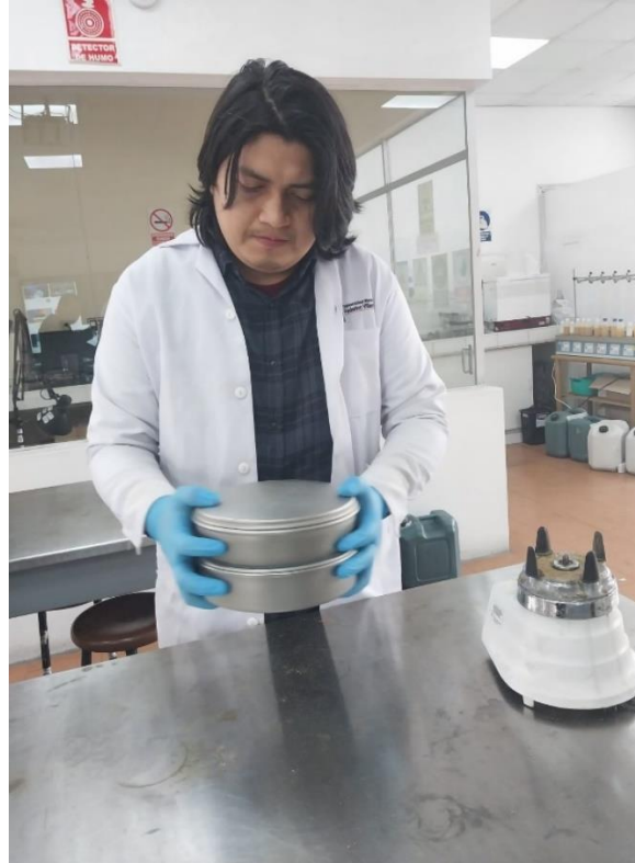
Tamizaje de Bioadsorbente de naranja con la malla #80
