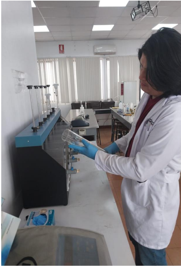
Llenado de muestras de agua residual en las Jarras del Floculador
