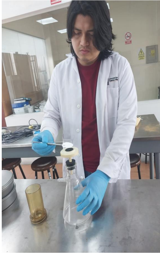
Colocación del filtro para la determinación de Sólidos en Suspensión
