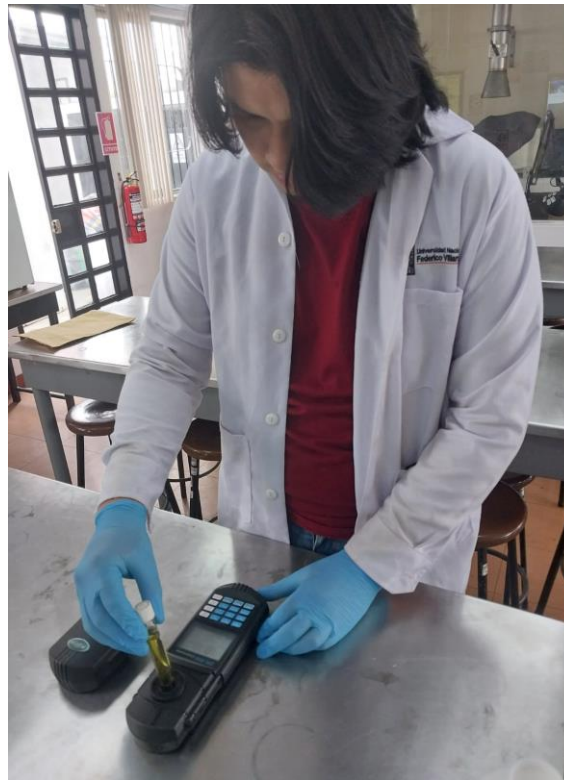
Cuantificación de la DQO en el Colorímetro
