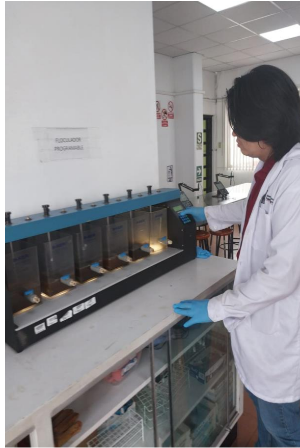
Corrida de las muestras en el Floculador Programable
